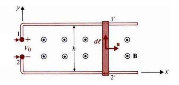
$$\begin{split} \Phi_{\rm dynm} = \int_S \vec{B} \cdot \underline{d\vec{s}} &= B_0 hut, \ \Rightarrow V_0 = -\frac{d}{dt} \Phi_{\rm dynm} = -B_0 hu \\ \frac{\sim + d\vec{z}}{\sim} \end{split}$$
