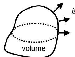
$$\iiint_{Volume} (\vec{H} \cdot \nabla \times \vec{E} - \vec{E} \cdot \nabla \times \vec{H}) dv = \iint_{surface} (\vec{E} \times \vec{H}) \cdot \hat{n} ds$$
