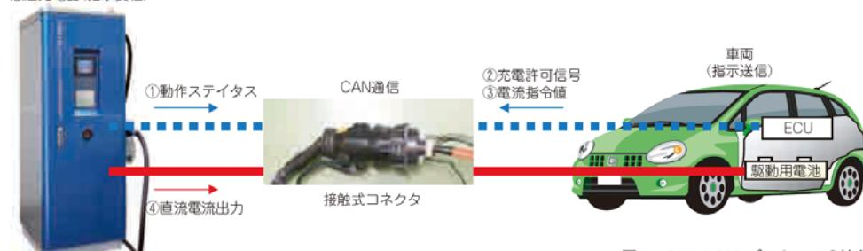
図 2 CHAdeMO プロトコルの流れ
